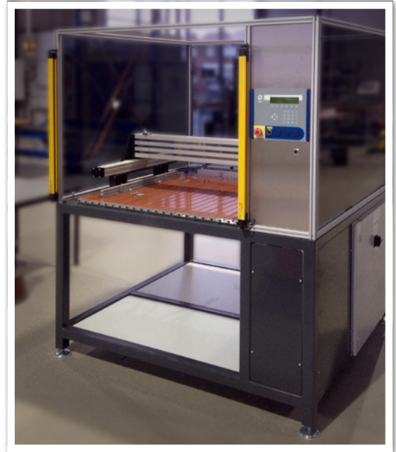
Bolzenschweißmaschine der der Größenklasse ZM mit Umhausung und Maschinengestell in verwindungssteifer Stahl-Konstruktion. Das Automationskonzept ist ausgelegt für die Integration aller gängigen Bolzenschweißtechnologien.
