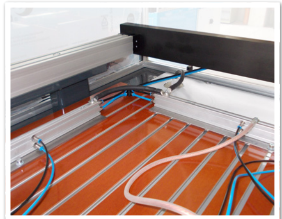
Nullpunktanschlagsleisten bieten viele Möglichkeiten, benötigte Pneumatik- und Elektroverbindungen anzuschließen.
