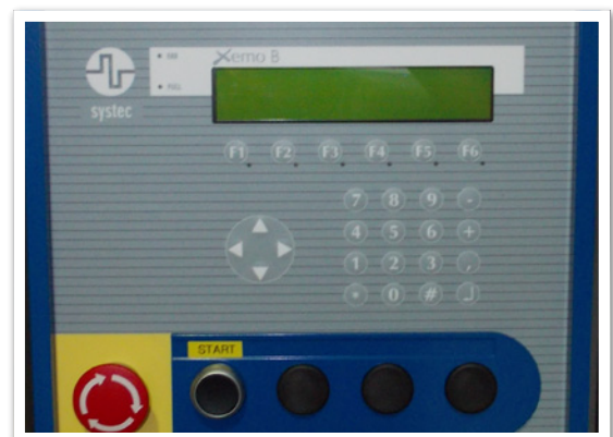
Bedienteil der integrierten Xemo-Steuerung. Vordefinierte Bolzenschweiß-Programme werden über Funktionstasten aufgerufen
