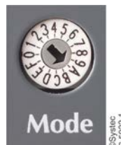
Abb. 1 Betriebsartenschalter in Stellung "A"
